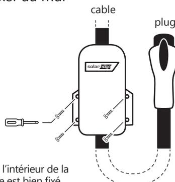
**i** Positionner le revêtement en caoutchouc à l'intérieur de la rainure du câble, pour s'assurer que le câble est bien fixé
